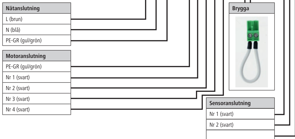
Bild 7: Kopplingsschema för kretskortet med kondensator - Uno
