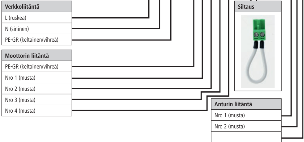
Kuva 7: Piirilevyn ja kondensaattorin kytkentäkaavio - Uno
