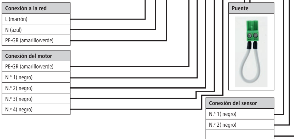
Figura 7: Esquema de conexiones del circuito impreso con condensador (Uno)
